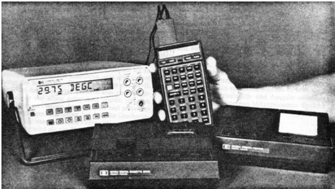
Bild 1. Einfaches HP-IL System unter Benutzung des Taschenrechners HP-41C, des Multimeters HP 3468A und eines Thermodruckers
